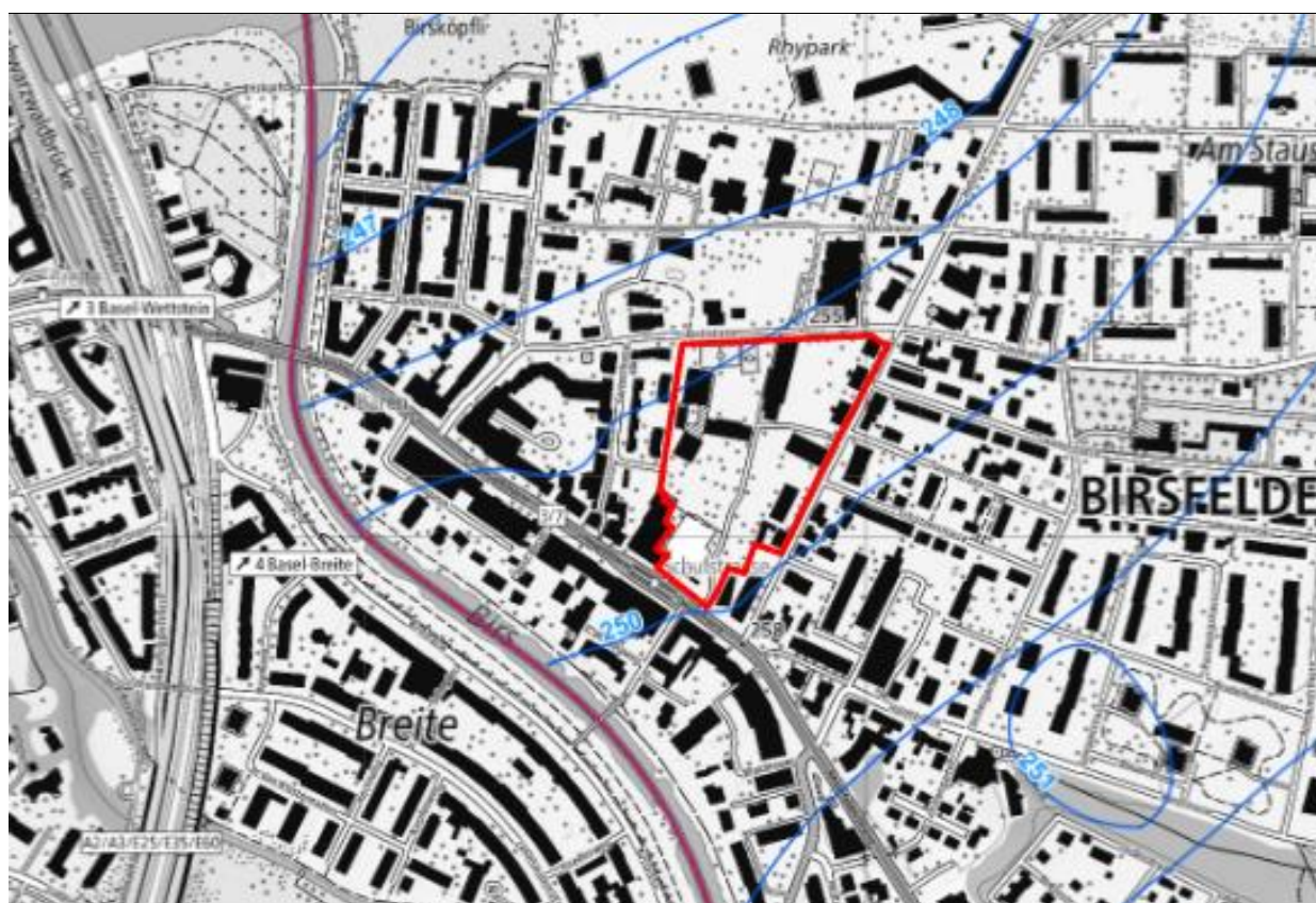
Abbildung 14: Grundwasserisohypsen Mittelwasser in m. ü. M. (GeoView BL 2024)
